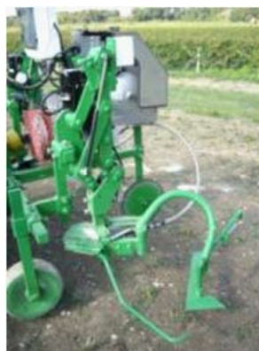
Dispositif Souslikoff d'assistance pneumatique et de régulation de la profondeur (crédit Souslikoff)
