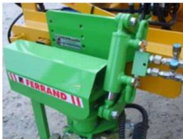
Vérin de contrôle du dévers Ferrand (crédit Ferrand)
