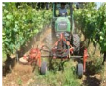
Montage à l'avant du Starmatic de Boisselet (crédit Boisselet)
