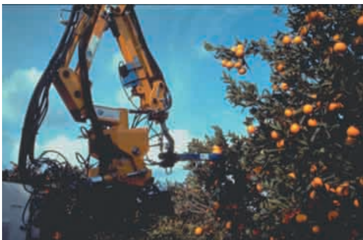
Figure 7 : prototype de récolte des oranges (Citrus)
