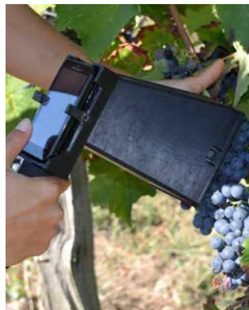
Pendant les vendanges 2013, l'IFV Sud-Ouest a testé le SmartGrappe afin de déterminer le pourcentage de véraison
