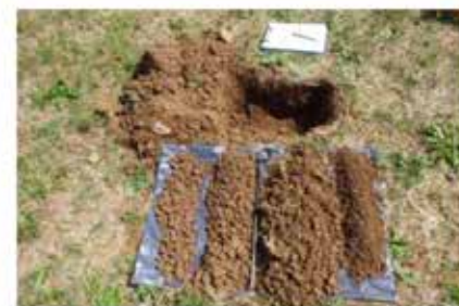
4. Observer la proportion de terre fine, les différentes classes de mottes, les cailloux...
