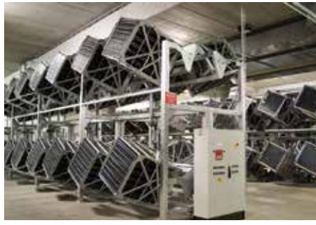
Les installations modernes de Mezzacorona composées de nombreux gyropalettes permettent de réaliser le remuage en 7 jours
