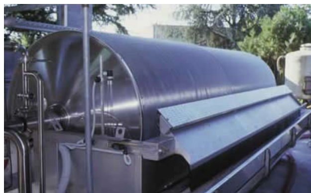
Le filtre rotatif sous vide reste encore la référence. Les déchets qu'il génère, leur gestion environnementale et son coût de fonctionnement élevé pourrait cependant bien avoir raison de lui
