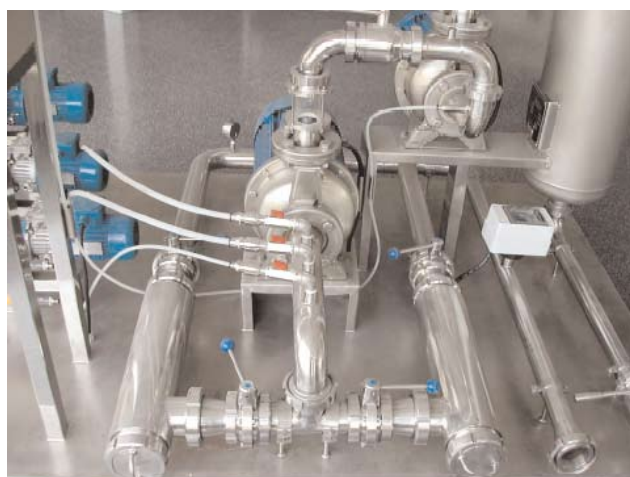
Exemple d'une installation de flottation, le FL300 testé au cours de notre étude (Crédit photo Agrovin)
