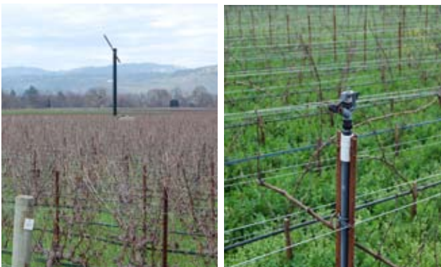
Lutte contre le gel de printemps chez Opus One : à gauche par brassage d'air (une hélice protège 4 ha) et à droite par aspersion
